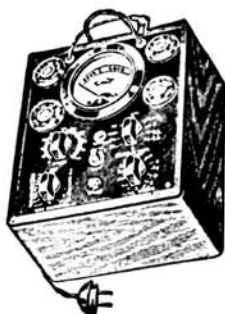
Fig. 280. - Strumento prova-valvole a lettura diretta.
