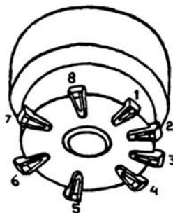
Fig. 234. - Zoccolo delle moderne valvole per cc/ca.
