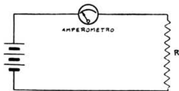
Fig. 265. - Come si usa l'amperometro o il milliamperometro.
