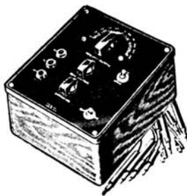
Fig. 284. - Oscillatore modulato a tre gamme d'onda: corte, medie e lunghe.
